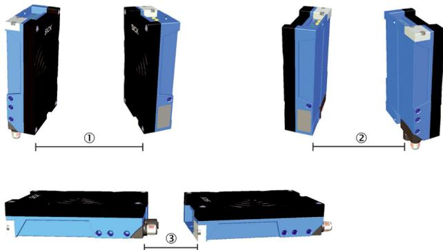
Distancias requeridas para impedir la interferencia mutua en caso de montaje de dos dispositivos.
